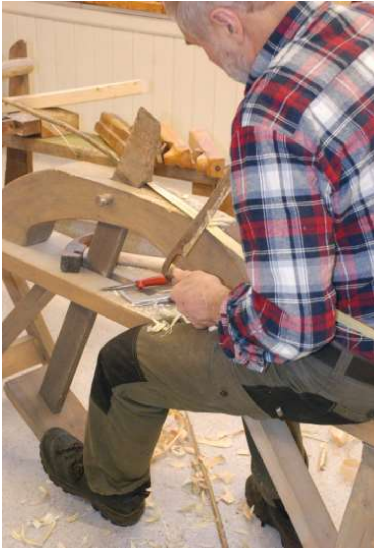
Jostein smir bånd ved hjelp av båndkrakk og båndkniv. Han er bøkker og er vant til båndkrakk og tillaging av tønnebånd i hassel.
