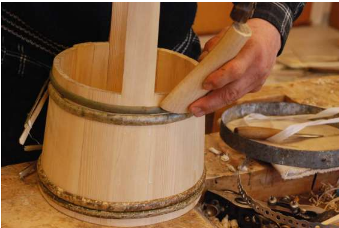
Øyvind driver på plass siste bånd på karet. Etter tørking blir båndene litt løsere, så det er viktig at de presser skikkelig rundt stavene.
